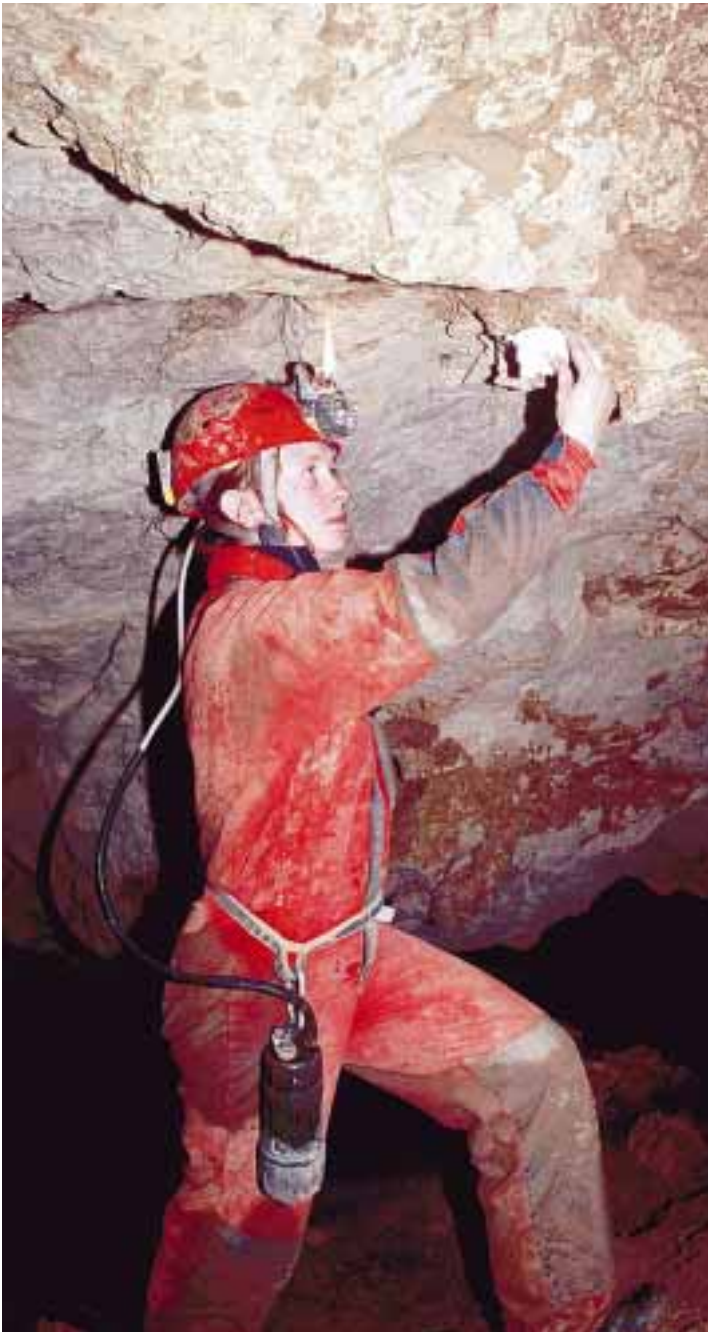
RAD U ŠPILJI: Jana Bedek prilikom postavljanja termohigrometra, trajnog mjerača temperature i vlage u špilji
